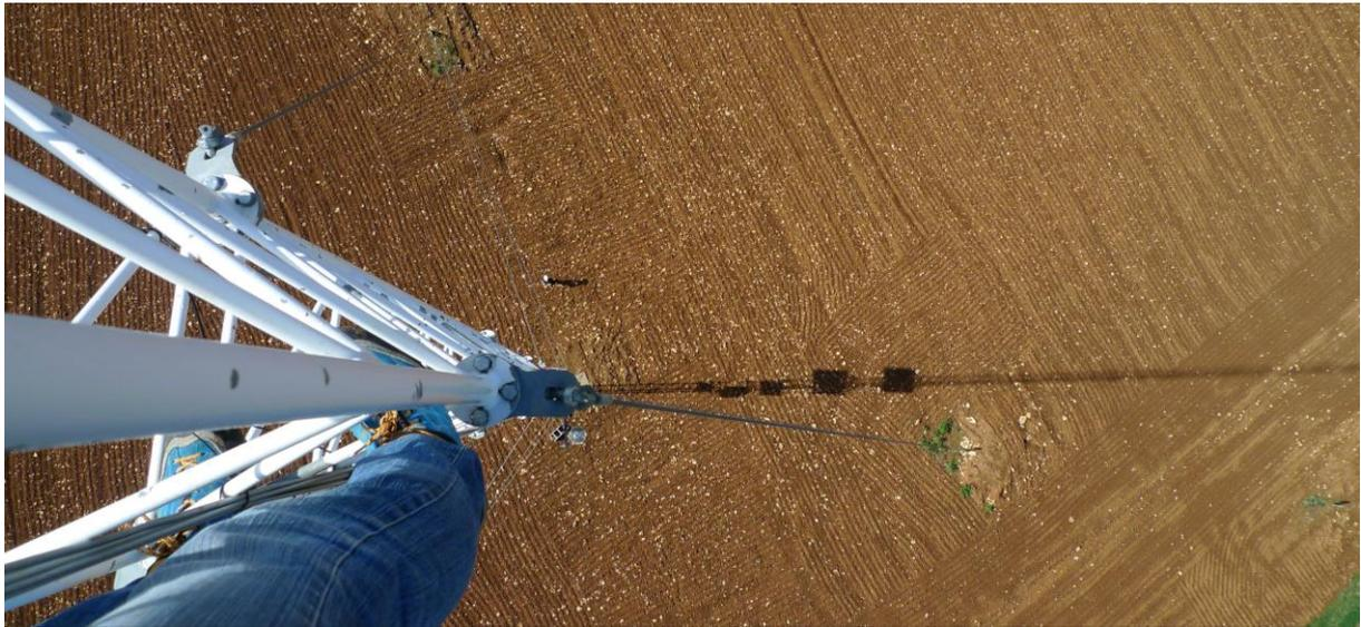
La pose d'un micro en hauteur nécessite une habilitation et permet de réaliser des enregistrements à hauteur de rotor.
